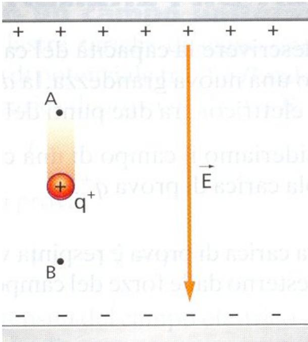
Energia potenziale nel campo elettrico generato da un condensatore
