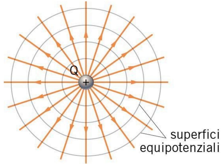
In figura sono rappresentate le linee di forza e le superfici equipotenziali del campo elettrico generato da una e da due cariche. Dall'esame della figura si vede che:
