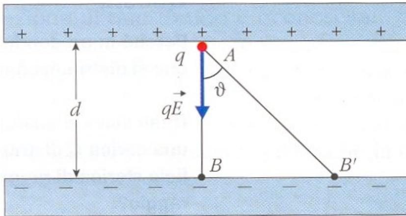
Consideriamo il campo elettrico uniforme di un condensatore piano e supponiamo che una carica  $q$  positiva si sposti dalla piastra positiva alla piastra negativa.
